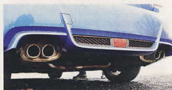
▲ Výfukové potrubí je nové, zni hrubě. Každá koncovka má průměr 80 mm.
