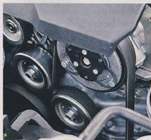
▲ Zcela nový celohliníkový motor FB20 nahrazuje původní boxer EJ20. Plochý řemen nově pohání také vodní pumpu.
