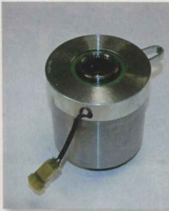
▲ Elektromagnetickou spojku poznáte podle typické „pupeční šňůry“.
