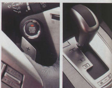
Samočinná převodovka má jen pět stupňů, ručně lze řídit jen tlačítky pod volantem
