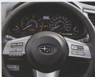
◀ Telefon, audiosystém nebo tempomat lze ovládat přímo na dvouse nastavitelném volantu
