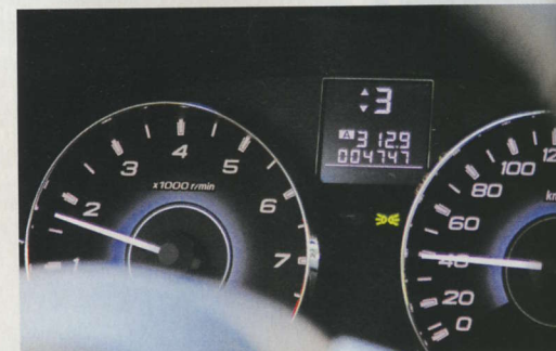
Na displeji v přístrojovém štítu řidič vidí, který stupeň má právě zařazený.
