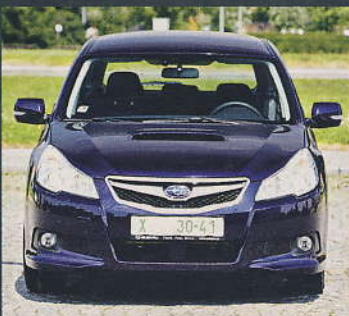
▲ Otvorem v kapotě se přivádí vzduch k chladiči stlačeného vzduchu.
