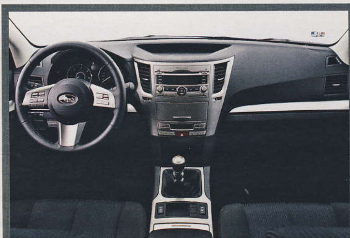
▲ Legacy – manuál se šesti stupni vyniká poměrně přesným řazením, byť její řadicí páka stále vyžaduje o něco více síly, než je nutné u konkurence.
