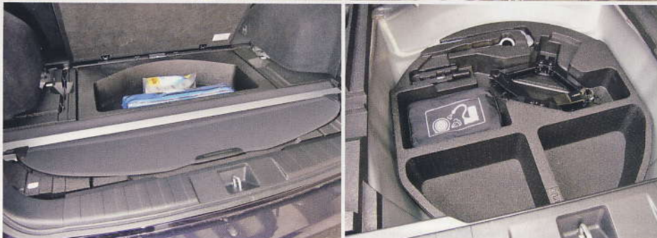
Pod výklopnou podlahou zavazadlového prostoru je vyjímatelná schránka s dalším úložným prostorem a místem pro uložení svinovacího krytu
