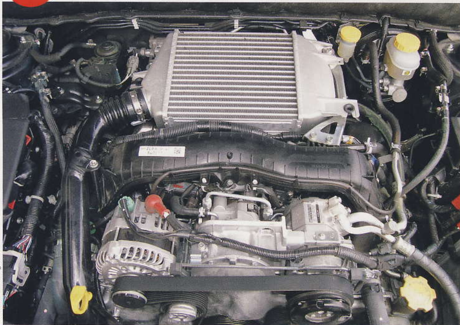
Plochý vznetový čtyřválec je skryt pod chladičem vzduchu stlačeného turbodmychadlem
