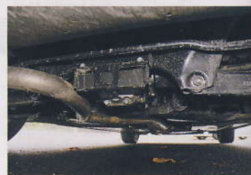
Pohon 4 x 4 zajišťuje mezinápravový diferenciál s viskózní spojkou. Mimo silnici dejte pozor na nízký podvozek.
