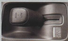
*Pětistupňová převodovka má krátké dráhy a přesný chod, chce to však cvik. Redukci uplatníte při tažení přívěsu či v terénu.*
