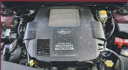
Přeplňovaný turbodieselový boxer 2,0 l má výkon 150 koní a jeho charakteristika připomíná spíše zážehové bratry s protilehlým uspořádáním válců
