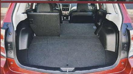
Zadními výklopnými dveřmi dobře přístupný zavazadlový prostor s vyšší nakládací hranou nabízí v základním uspořádání slušný základní objem 0,450 m<sup>3</sup>
