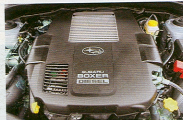
Čtyřválcový vznětový boxer přispívá k nízkému těžišti a běží velmi vyrovnaně
