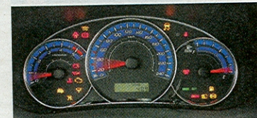
Budíky jako u Foresteru: modrý podklad, kontrolka žhavení a filtru pevných částic
