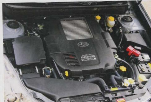
Turbodiesel s protilehlými válci vyniká kultivovaností a velmi úsporným provozem.
