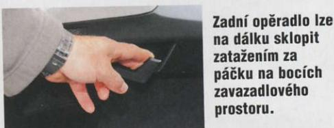
Zadní opěradlo lze na dálku sklopit zatažením za páčku na bocích zavazadlového prostoru.
