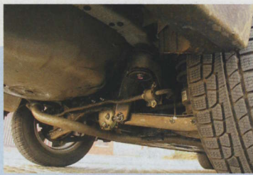
Ústrojí trvalého pohonu 4 x 4 by mohlo být lépe chráněno před poškozením
