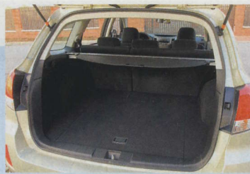
Za světlou výškou 200 mm a pohon všech kol se platí vyšší nakládací hranou
