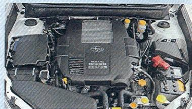
Plochý turbodiesel 2.0 D/110 kW zatahuje krásně plynule. Turbodiesel se kvůli snížení těžiště nachází pod motorem.
