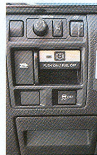
Ve výbavě nechybí samočinná parkovací brzda a hill-holder. Ten na rozdíl od konkurence drží vůz ve svahu do chvíle, než řidič šlápně na plyn, nikoli pouhé tři sekundy.
