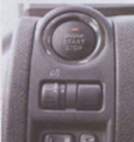
Součástí standardní výbavy se nově stává i keyless entry s impulsním startovacím tlačítkem
