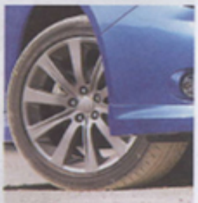
Lehčí kola se významně podílejí na lepším překonávání krátkých nerovností Foto P.HOMOLKA
